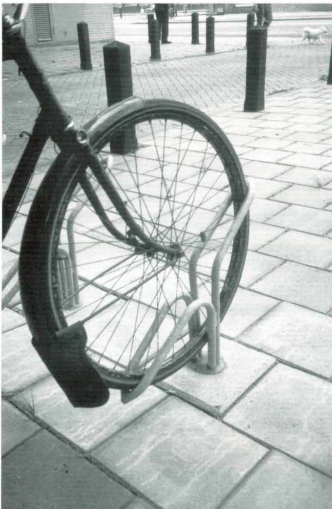
Figuur 33. Klemsysteem voor voorwiel.
