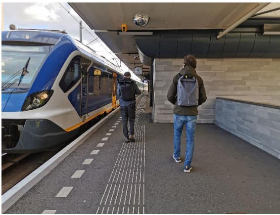
Obstakel op treinperron blokkeert doorstroming en zichtlijn
