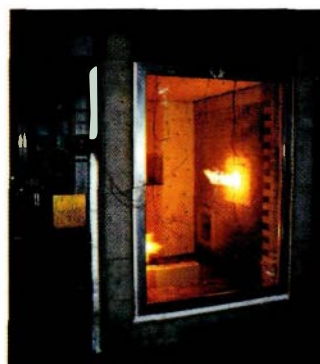
Alcoa aluminium raamconstructie met Vetroflam dubbele beglazing, type RT 62, 68 minuten brandwerend 'van buiten naar binnen' volgens NEN 6069:1997.
