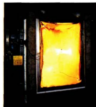
Alcoa aluminium raamconstructie met Vetroflam dubbele beglazing, type RT 62, 68 minuten brandwerend 'van buiten naar binnen' volgens NEN 6069:1997.
