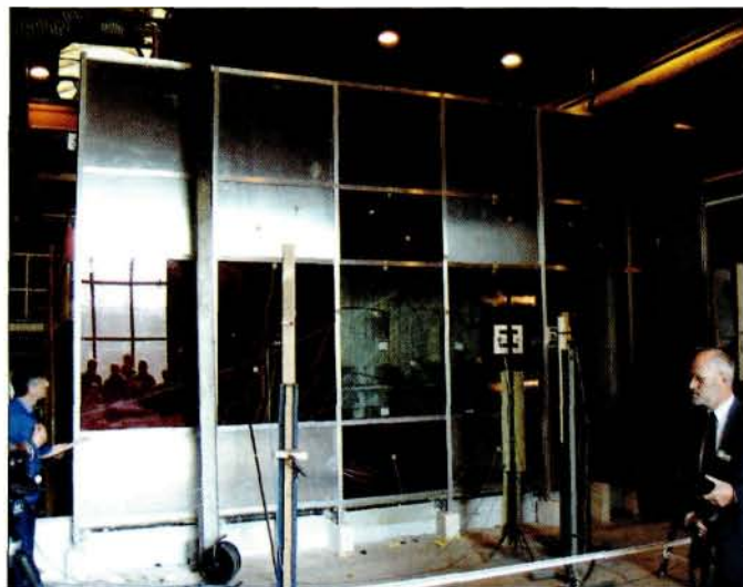
Alcoa vliesgevelelement in testruimte TNO Centrum voor Brandveiligheid. Het grootformaat vliesgevelelement, met aansluitingen op vloer en binnenwanden, en voorzien van glas, emaillet en alu-panelen, is conform Europese normen getest en haalde een WBDBO van 131 minuten.
