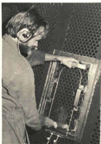
Uitvoering van een lekdichtheidsonderzoek in een grote warmtewisselaar.
