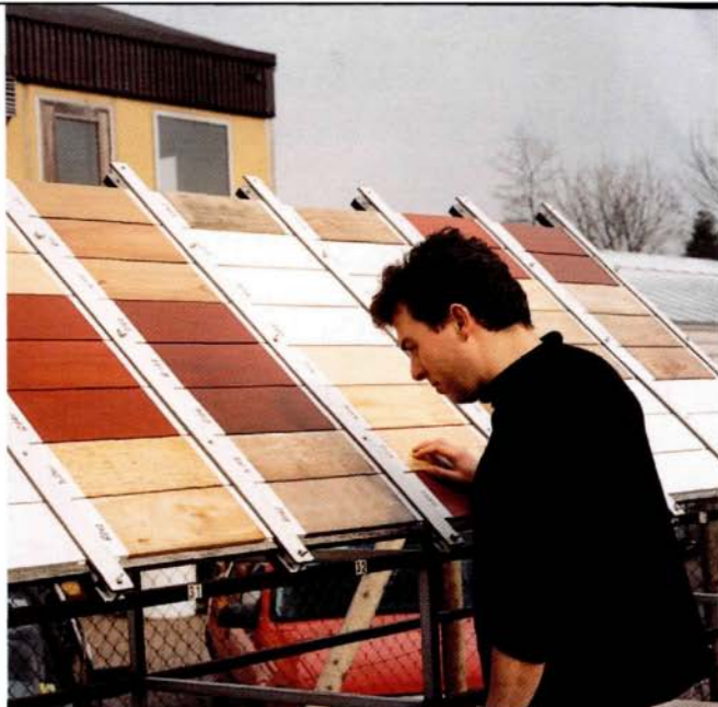
Ook de sectie Coatings van SHR onderzoekt de inwerking van verf op hout.
