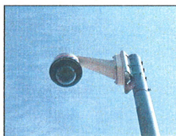
Dome-camera's kunnen bewegen en inzoomen waardoor veel beter bewijsmateriaal kan worden verzameld dan met vaste camera's.
