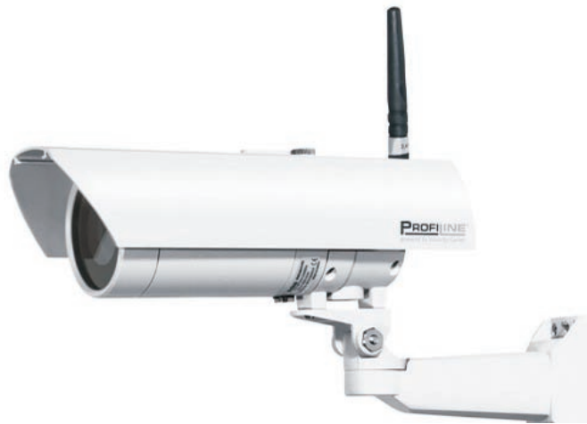
Afbeelding 2.4.7.6-1: Ook een draadloze camera, te herkennen aan het 'sprietje' moet 'voeding' krijgen. Uit het lichtnet, uit een accu of hoe dan ook, maar 'draadloos' slaat enkel en alleen op de signaaloverdracht!
