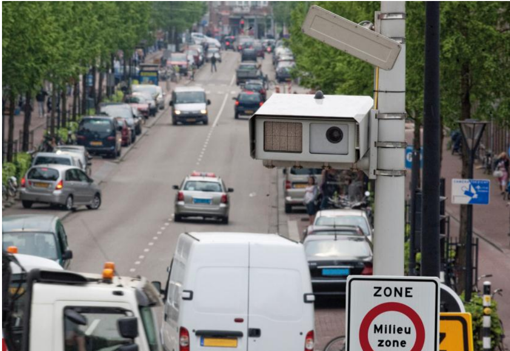
Milieu Zone Amsterdam – Handhavingscamera's waken vrachtwagens met oude vervuilende dieselmotoren op basis van ANPR (Automatic Number Plate Recognition)
